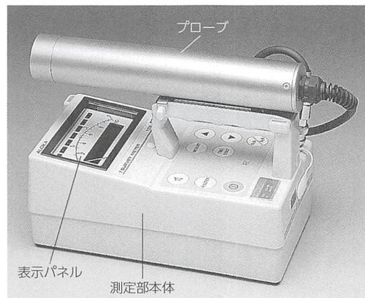
図23 NaI (Tl) シンチレーション式スペクトル・サーベイメータ
