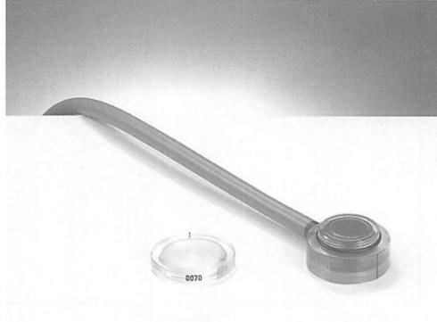
平行平板型の電極がプラスチックなどの支持体に埋め込まれており、電極間隔は極めて小さい(2mm以下)。入射窓も非常に薄い(0.01~0.03mm厚のマイラーやポリエチレンなど)ことから、低エネルギー光子や電子線による物質表面近傍の吸収線量測定に利用される。構造を図14に示す。平行平板型電離箱の大きな特徴として、「**極性効果**<sup>\*11</sup>」があげられる。
