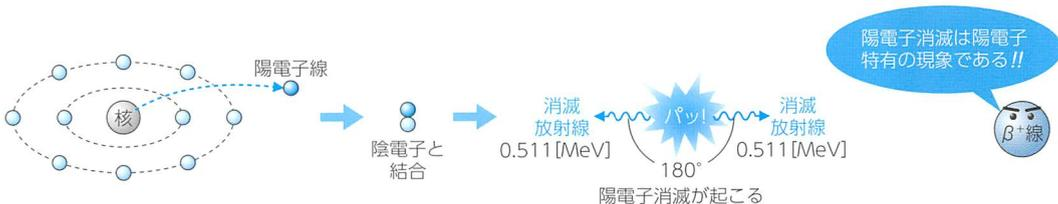
陽電子消滅とは、陽電子線が物質内で運動エネルギーを失い、静止状態に近くなるとすぐさま近くの自由電子(陰電子)と結合する現象である。陽電子消滅が起こると、結合した陽電子と陰電子が消滅し、その代わりに $0.511\text{MeV}$ のエネルギーをもった2本の「消滅放射線」とよばれる電磁波が互いに $180^\circ$ 反対方向に発生する。核医学検査におけるPET検査は、この
